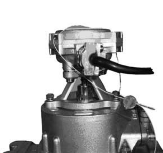
Рис.2. Пломбировка датчика расхода топлива
