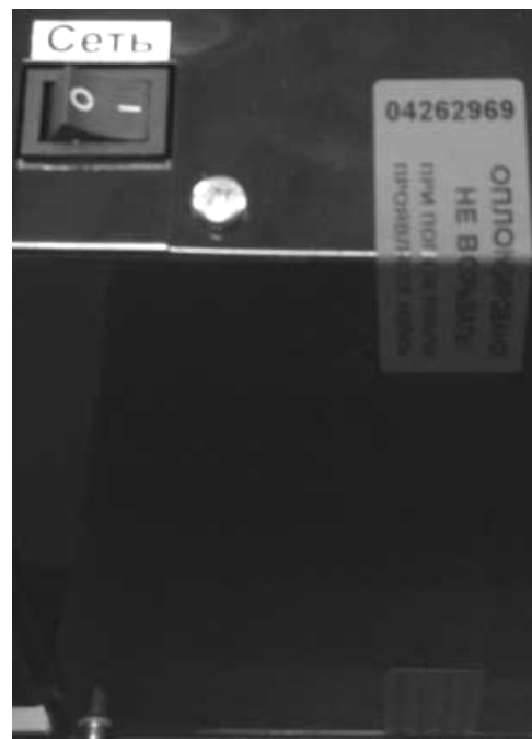
Рис.4. Пломбировка корпуса блока управления
